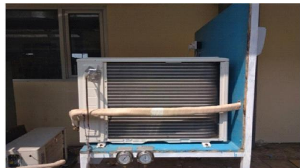
Gambar 5. Penampang depan kondensor
