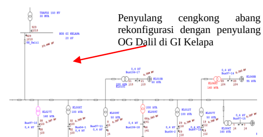
Gambar 6b. Lanjutan Lokasi Penyulang Dalil di GI Kelapa Dalam Simulasi ETAP Setelah Rekonfigurasi
