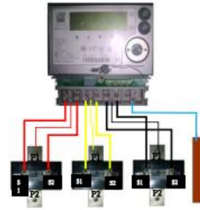
Gambar 16. Pengawatan sistem 3 Phasa Tidak Langsung
