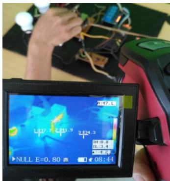
Gambar 10. Pengukuran suhu objek menggunakan thermovision selama 3 menit
