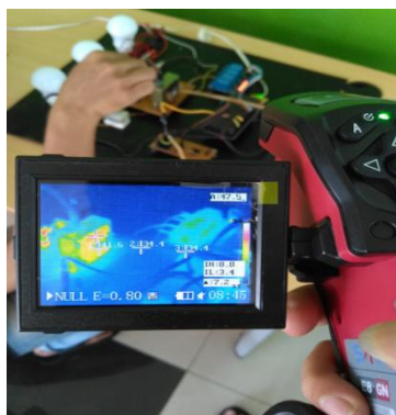
Gambar 11. Pengukuran suhu objek menggunakan thermovision selama 4 menit
