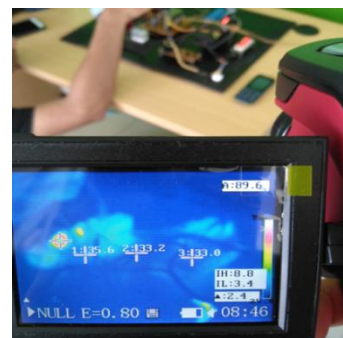
Gambar 9. Pengukuran suhu objek menggunakan thermovision selama 2 menit
