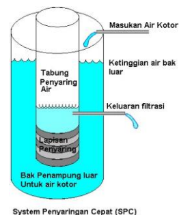
Gambar 6. Komposisi filter air
