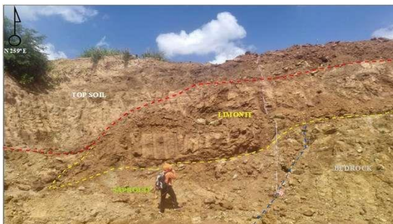
Gambar 8. Profil zonasi endapan nikel laterit ditutupi oleh lapisan sedimen.
