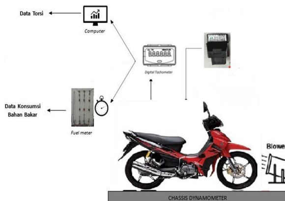
Gambar 2 Pengujian Daya dan Torsi menggunakan chasis dynamometer
