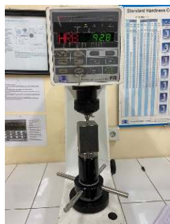
Gambar 6 Pengukuran kekerasan baja amutit
