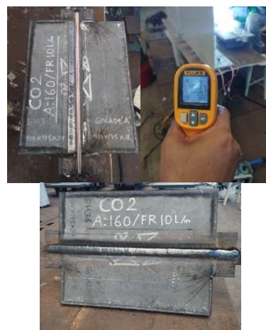
Gambar 3. Proses Fitting Spesimen, Kontrol Suhu Pengelasan dan Hasil Lasan
