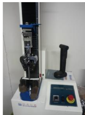
Gambar 3. Mesin pengujian lentur (bending testing machine) Beste KJ-1065
