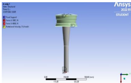
Gambar 3 Area pembebanan pada pengujian dynamic cornering fatigue .
