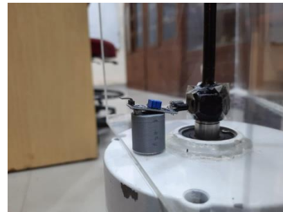
Gambar 6 Penempatan Sensor IR
