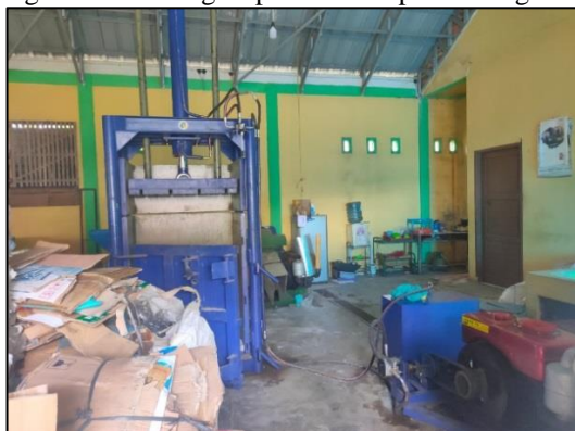
Gambar 7. Mesin Press Hidrolik Sampah
