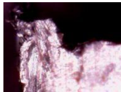
Gambar 6 Burr formation sebelum di ukur
