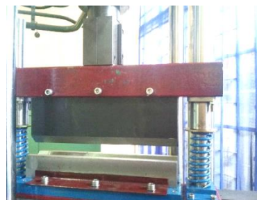
Gambar 11 Press Tool terpasang pada Universal Testing Machine (UTM)
