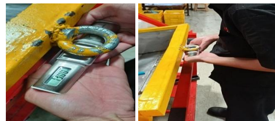
Gambar 14. Proses pengukuran beban tarik bak
