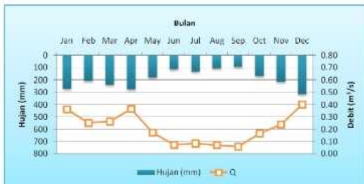
Gambar 4. Grafik hubungan antara hujan rerata bulanan & aliran yang masuk kolong berdasarkan data Klimatologi tahun 2000-2010
