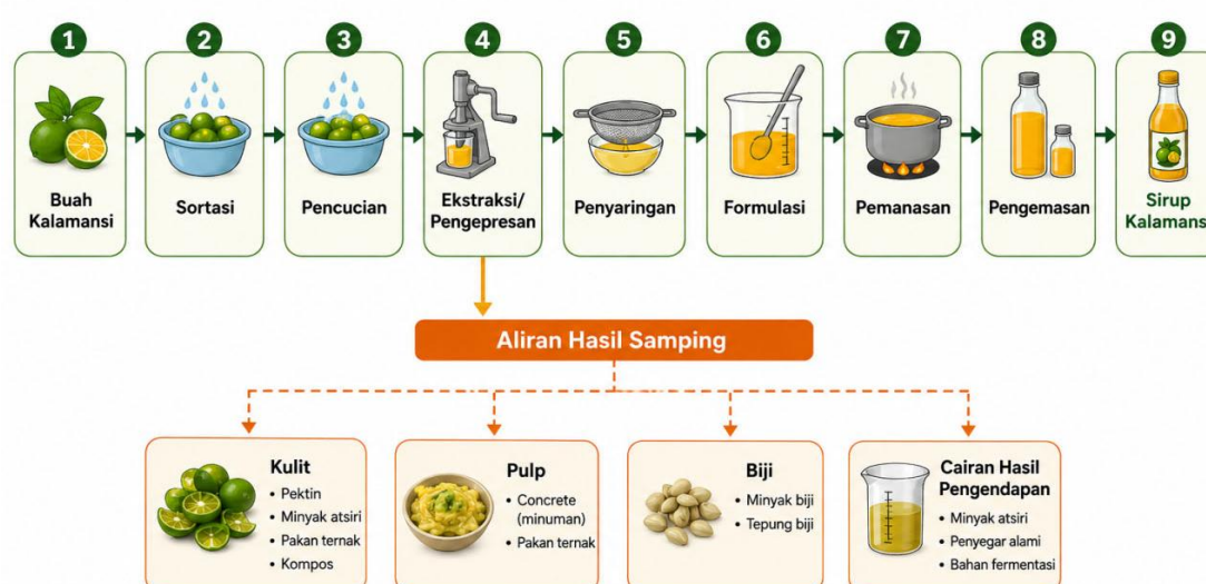
Gambar 1. Diagram Sistem Produksi dan Aliran Hasil Samping Agroindustri Sirup Kalamansi di Provinsi Bengkulu. Sumber: Diadaptasi dari Hidayat et al. (2018) dan Tutuarima et al. (2018).
