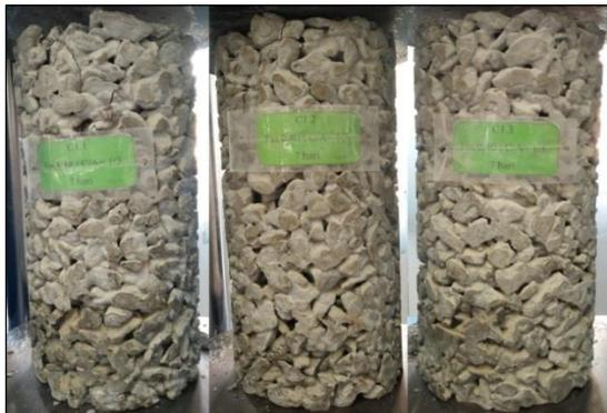
Gambar 6. Kerusakan benda uji kuat tekan (perbandingan semen : agregat 1 : 3 dan faktor air semen 0,4)
