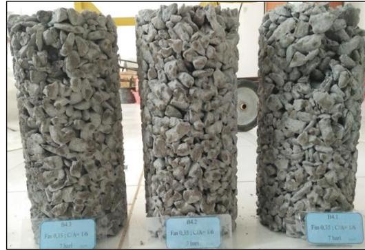
Gambar 8. Kerusakan benda uji kuat tekan (perbandingan semen : agregat 1 : 6 dan faktor air semen 0,35)
