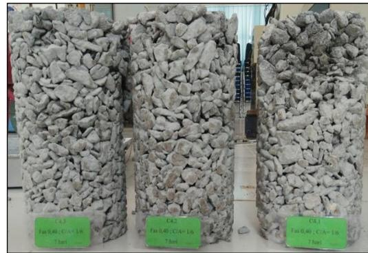
Gambar 9. Kerusakan benda uji kuat tekan (perbandingan semen : agregat 1 : 6 dan faktor air semen 0,4)
