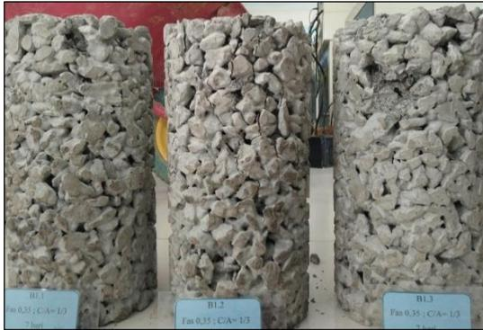
Gambar 5. Kerusakan benda uji kuat tekan (perbandingan semen : agregat 1 : 3 dan faktor air semen 0,35)
