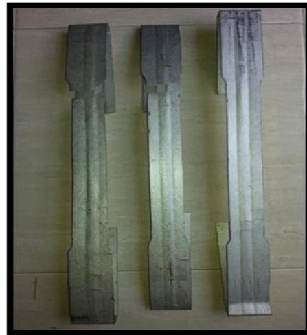
Gambar 3. Material baja ringan profil U tebal 0,45 setelah selesai pengujian.
